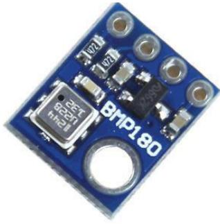
Figure 5: Capteur de pression BMP180.
